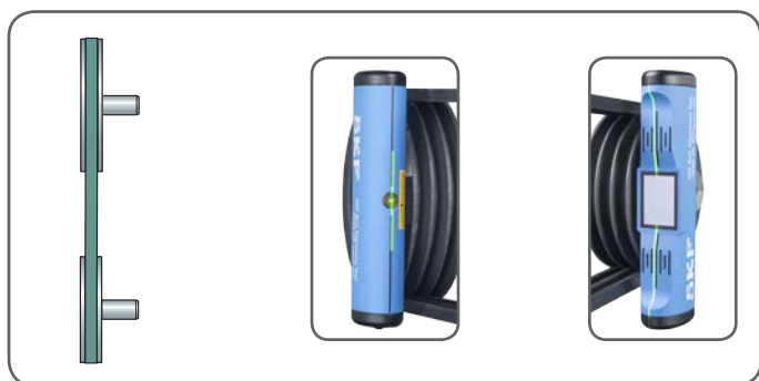
Figure 9 Pulegge perfettamente allineate
