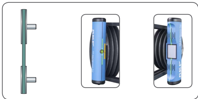
Figure 9 Poulies parfaitement alignées
