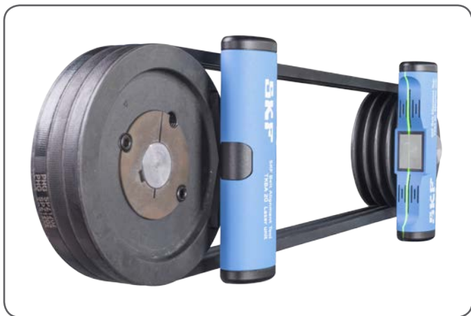
Abbildung 4 An den Riemenscheiben befestigte Einheiten
