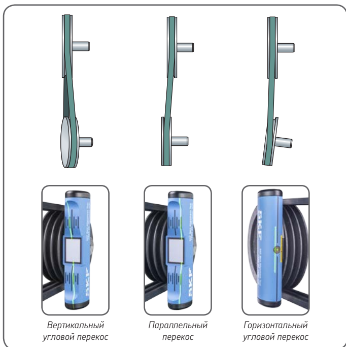
Рисунок 5 Определение типа перекося
