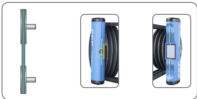
图 9 皮带轮已完美对中
